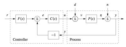
$$\begin{bmatrix} \eta \\ y \\ u \end{bmatrix} = \begin{bmatrix} \frac{P}{1+PC} & -\frac{PC}{1+PC} & \frac{PCF}{1+PC} \\ \frac{P}{1+PC} & \frac{1}{1+PC} & \frac{PCF}{1+PC} \\ -\frac{PC}{1+PC} & -\frac{C}{1+PC} & \frac{CF}{1+PC} \end{bmatrix} \begin{bmatrix} d \\ n \\ r \end{bmatrix}$$
