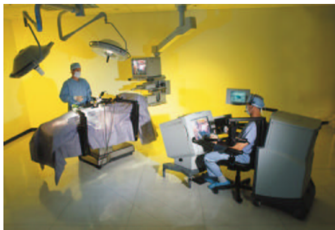
图 3.8: 由Computer Motion Inc. 开发的机器人外科手术系统ZEUS TM , 能完成远程的创口最小的显微手术。
