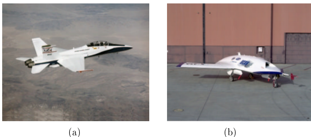
图 3.1: (a) F-18 战斗机, 批量生产的首先使用"线传操控(fly-by-wire)"技术的军用战斗机之一。(b) X-45 无人驾驶飞机(UCAV)
